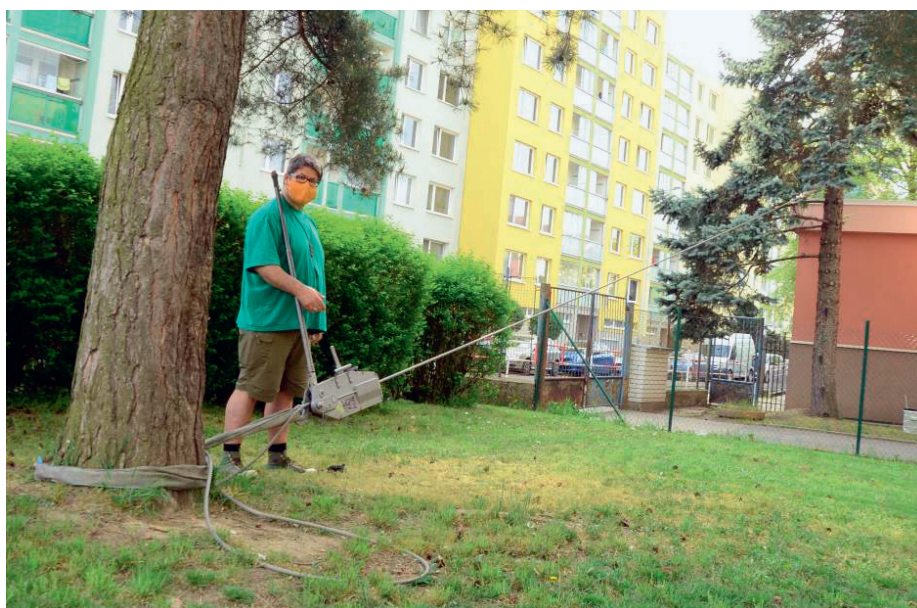
Obrázek 4-35 • Zatížení stromu lanovým navijákem při měření v terénu (foto archiv Arbonet).
