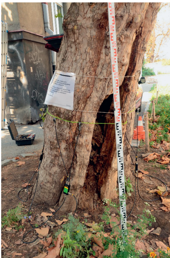
Obrázek 4-15 • Platan v ulici U Akademie v Praze 7 s rozsáhlou dutinou na bázi a velkým náklonem, negativně ovlivňujícími mechanickou stabilitu. V roce 2018 byla stabilita kvůli hrozbě zlomu kmene hodnocena jako špatná – stupeň 4. Po stabilizaci řezem a instalací podpěry v roce 2019 se mechanická stabilita stromu výrazně zvýšila. V době pořízení obrázku vpravo stabilizační efekt trvá a mechanická stabilita je proto hodnocena jako velmi dobrá až dobrá – stupeň 2 (foto archiv Arbonet).
