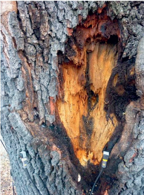
Obrázek 4-25 • Rozsáhlou hnilobu kmene dubu saturovaného vodou vykreslí tomogram jako hnilobu malého rozsahu (foto archiv Arbonet).
