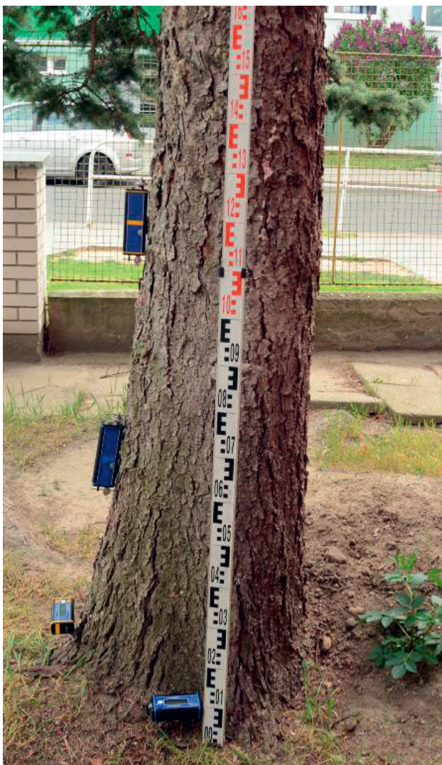
Obrázek 4-33 • Přístroje německé výroby PiCUS TreeQinetic pro tahovou zkoušku během měření (foto archiv Arbonet).
